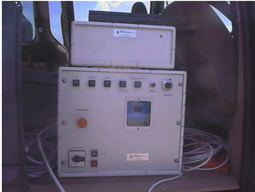
Foto n.2 - Centralina di controllo della vibrodina
